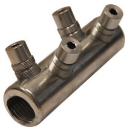
50-240 mm 2 Cu/Al Skjøtehylse med 2 knekkpunkt. Verktøy: Unbrako 8 mm
