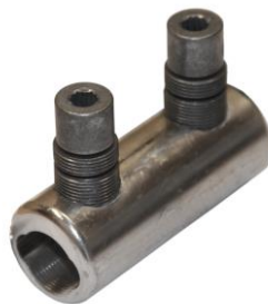
25-150 mm 2 Skjøtehylse med 2 knekkpunkt Verktøy: Unbrako 6 mm
